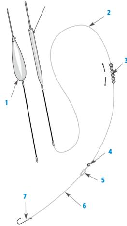
1. flotteur forme carotte ou olive allongée à antenne métallique 0,10 à 0,20 g
